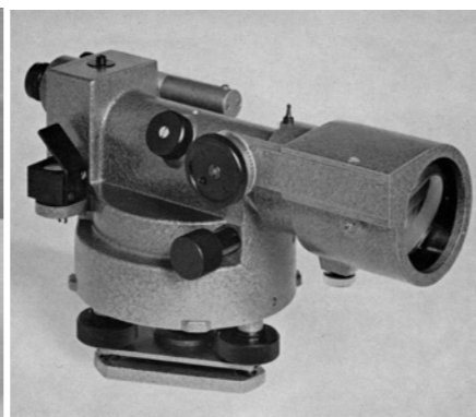
Ertel-Ingenieur-Nivellier mit automatischer Horizontierung der Ziellinie, gebaut ab 1955. Mit diesem Erfolgsmodell startete das Ertel-Werk seine Produktion in Puchheim. (Foto: Ertel-Festschrift 1962)
