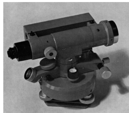
Ertel-Ingenieur-Nivellier, Baujahr 1948, mit wälzbarem Fernrohr und Reversionslibelle, Ausführung mit Horizontalkreis.
